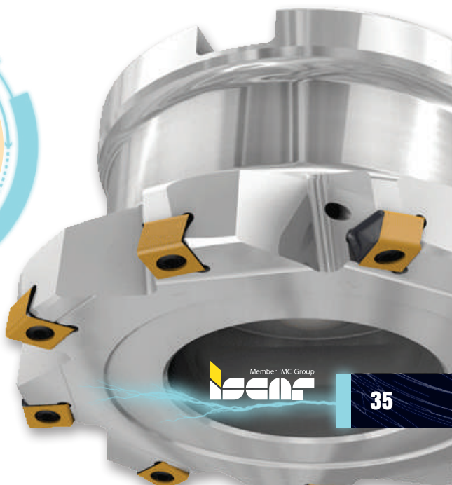
HTP…FR-P アルミニウム加工用 シャープ切刃/ポリッシュ処理 /ノンコート
