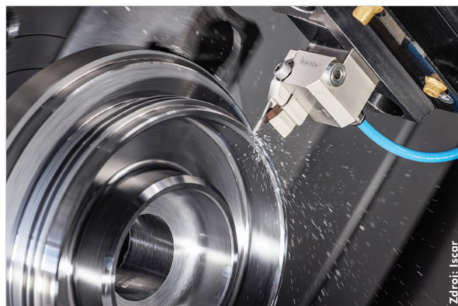
Úzké břitové destičky systému Cut-Grip jsou obzvláště efektivní v případech, kdy je nutno dbát na optimální tvorbu třísek.
