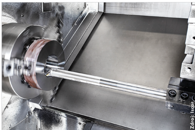
Antivibrační tyč Whisperline pro soustružení s velkým vyložením zvyšuje stabilitu a výkon obrábění díky potlačení vibrací.
