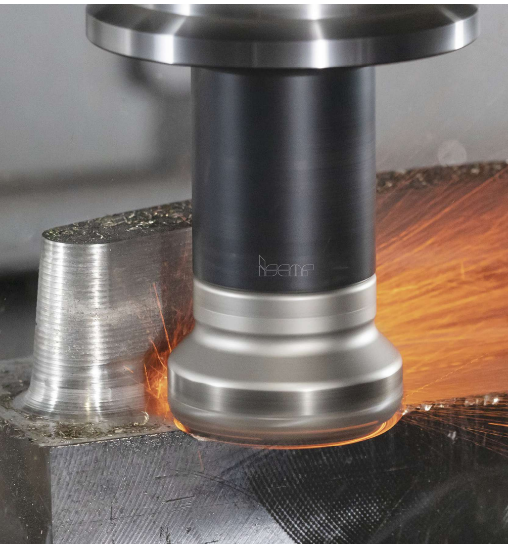
➔ Obr. 3: Strategie nástrojů ISCAR spíše kladou důraz na předvídatelné a opakovatelné opotřebení, než na maximální teoretickou životnost nástroje, protože předvídatelnost opotřebení zjednodušuje plánování výměny nástroje a snižuje riziko náhlého selhání nástroje u vysoce hodnotných obráběných leteckých dílů.
