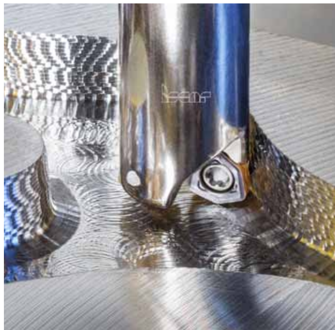
Obr. 2: Řada Micro-3-Feed ukazuje, že i při malých průměrech lze využít destičkový koncept pro produktivní frézování s vysokými posuvy a s nižší spotřebou karbidu
