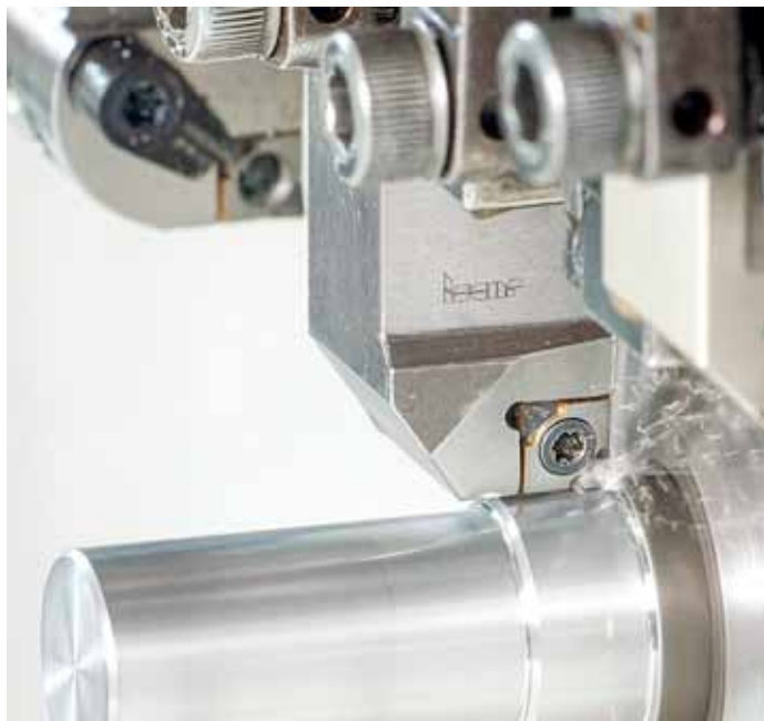
Obr. 3: Menší oboustranná destička z řady Logiq-4-Turn přináší čtyři využitelné řezné hrany a lepší ekonomiku při soustružení menších součástí
