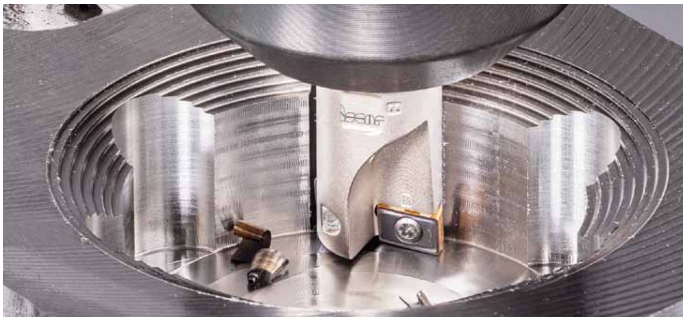
Obr. 5: Multifunkční nástroje z řady Quick-D-Mill pro operace vrtání a frézování prokazatelně zvyšují využití obdélníkových destiček a zkracují vedlejší časy
