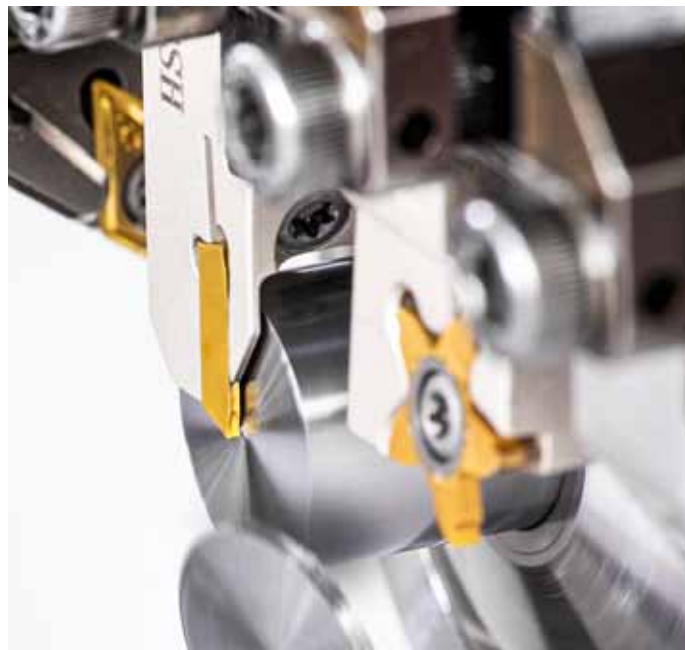
Obr. 4: Úzké oboustranné destičky Do-Grip efektivně využívají řezný materiál a snižují ztráty na materiálu obrobku při zapichování a upichování
