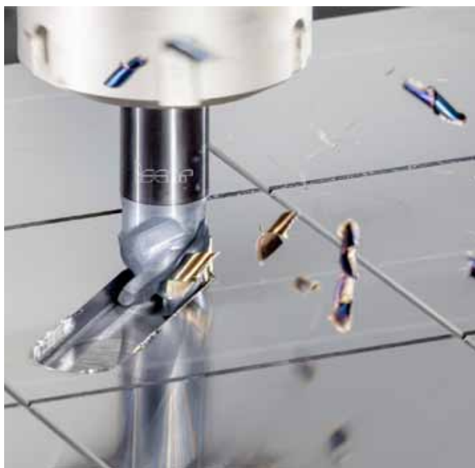
Obr. 1: Systém Multi-Master představuje příklad moduluárního nástroje s vyměnitelnou karbidovou hlavicí, který umožňuje hospodárně využít řezný materiál a současně zachovat vysokou flexibilitu použití
