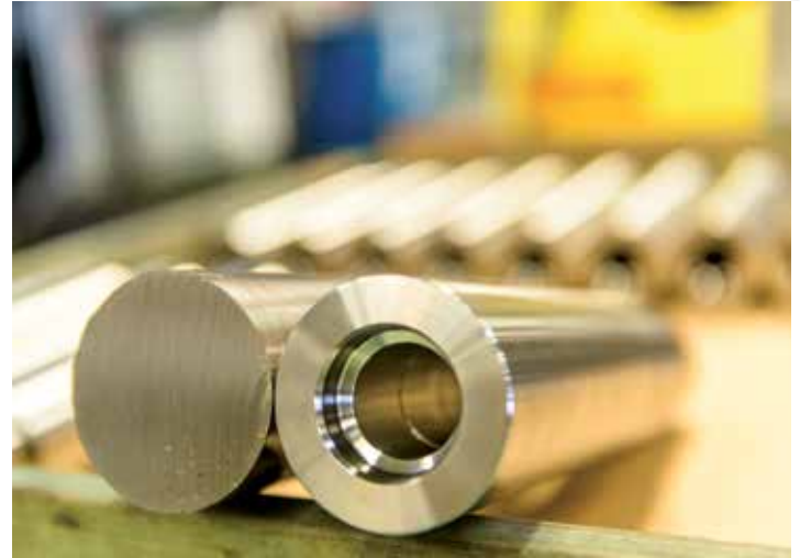
Drivaxel före och efter svarning.
