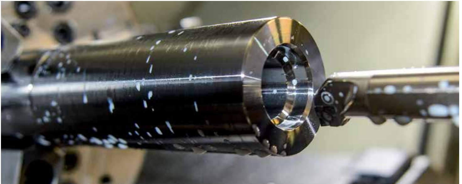
Inspänningen av CXMG-skäret i den laxstjärtformade fickan ger överlägsen stabilitet och ökad livslängd.
